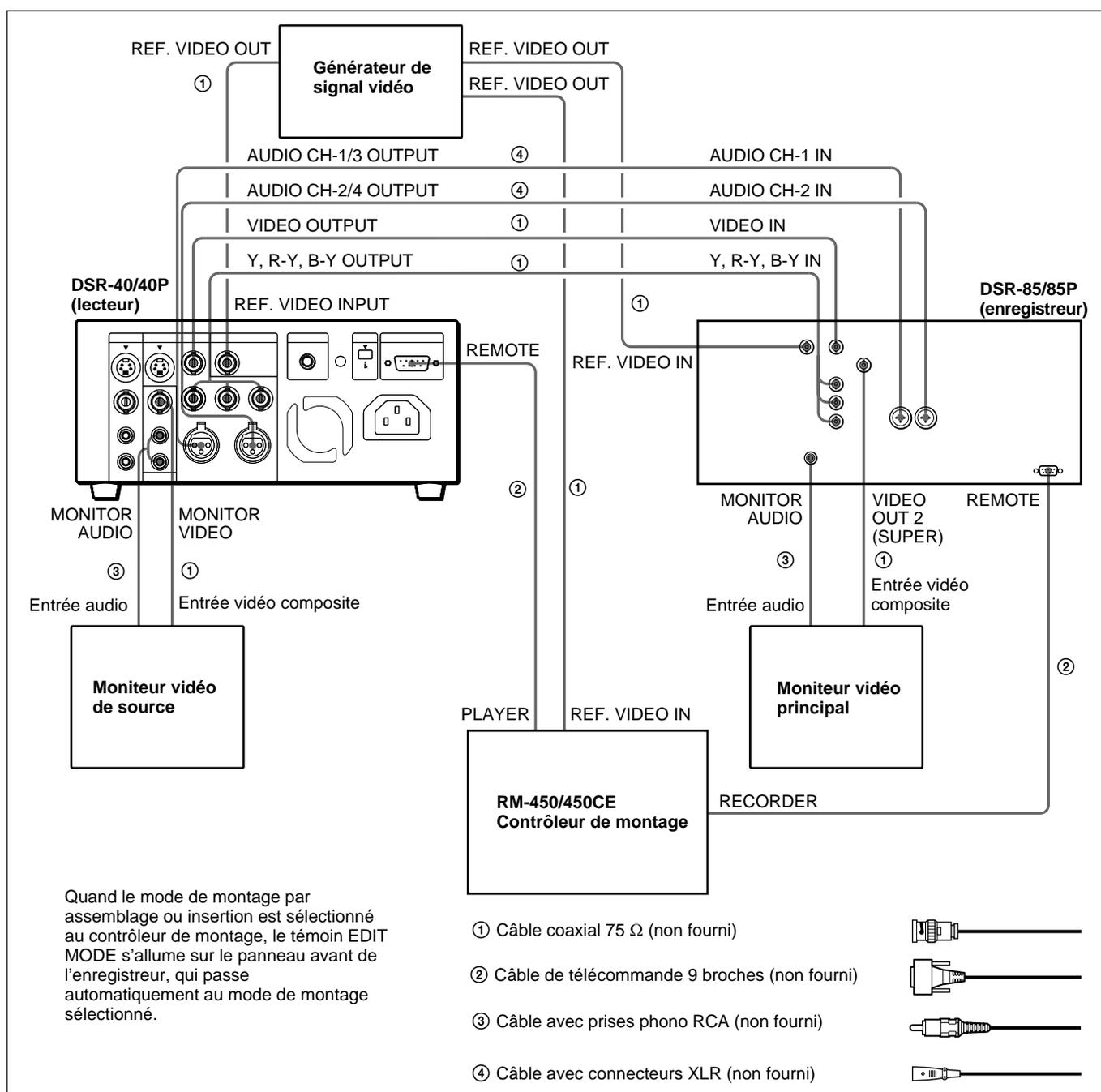
Quand le mode de montage par assemblage ou insertion est sélectionné au contrôleur de montage, le témoin EDIT MODE s'allume sur le panneau avant de l'enregistreur, qui passe automatiquement au mode de montage sélectionné.
